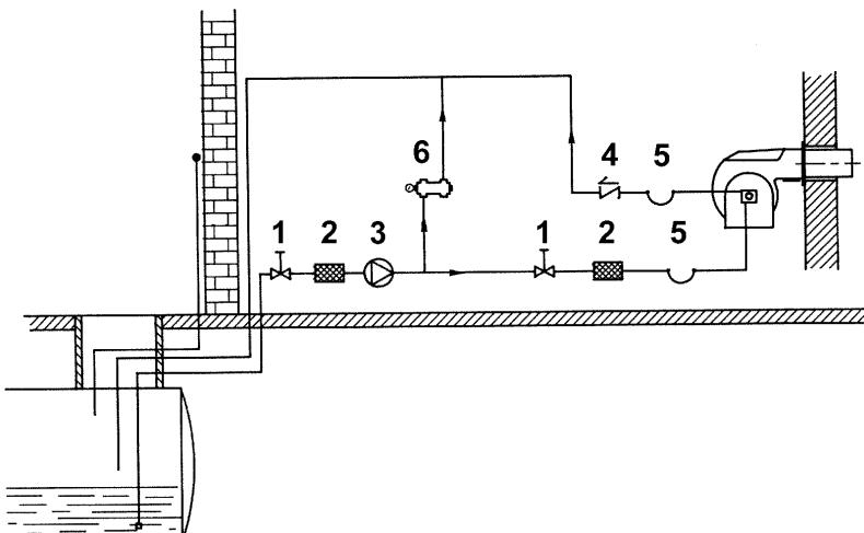
Рис. 5- - Контур подачи топлива всасыванием
