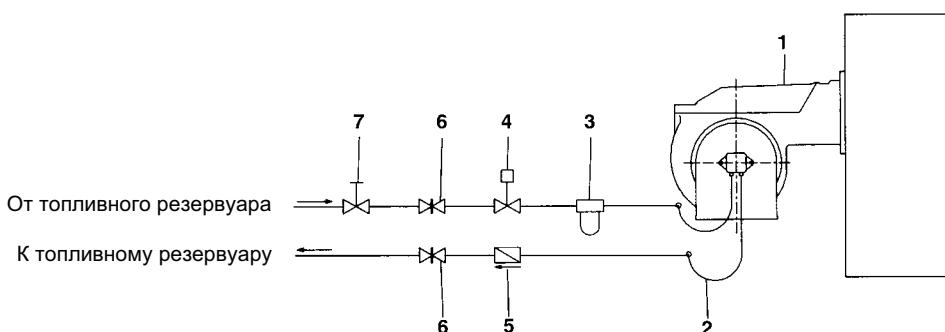
Рис. 6 - Двутрубная система
