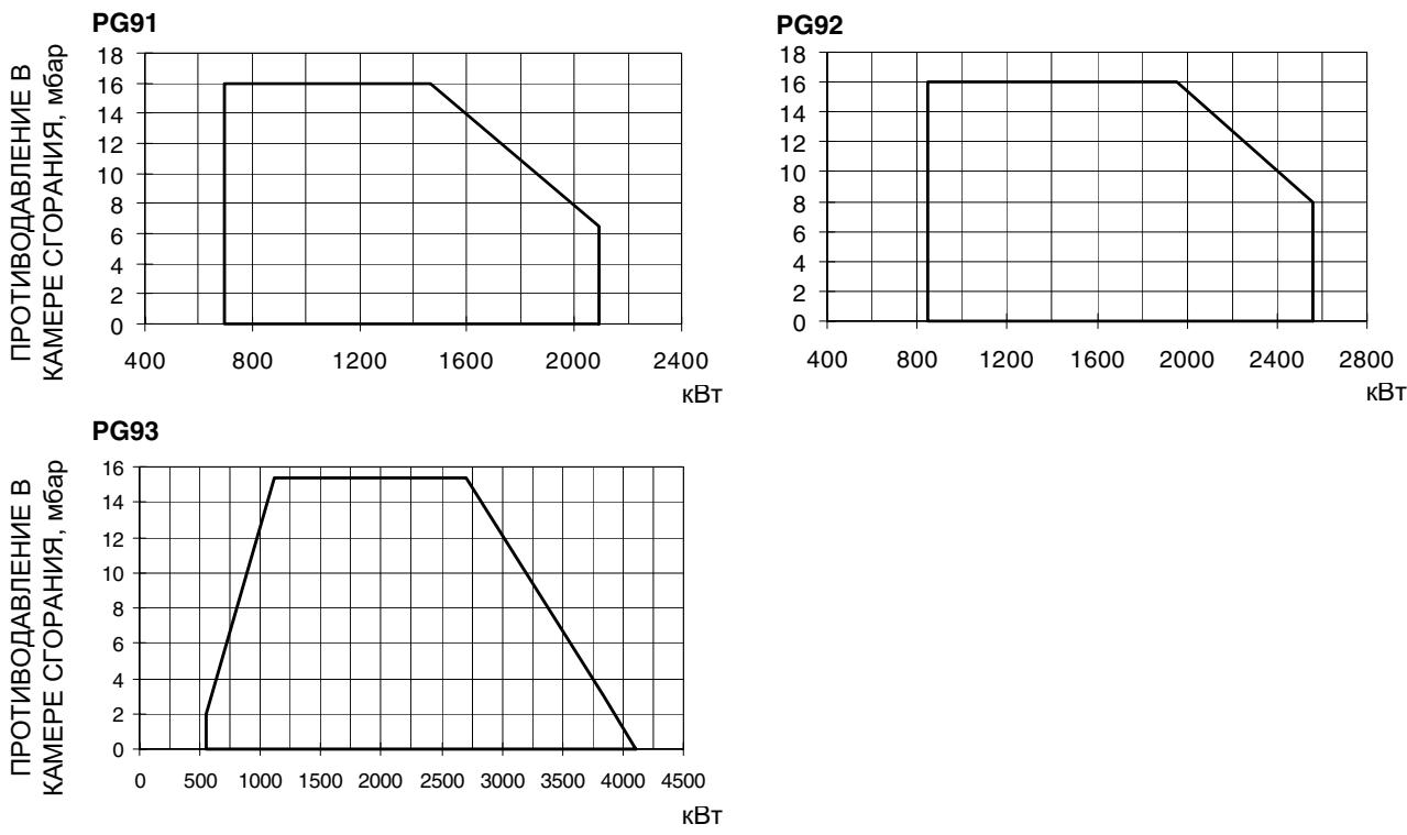
Чтобы получить мощность в ккал/ч, умножьте значение в кВт на 860.
