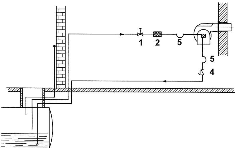
**ПРИМЕЧАНИЕ** В системах с гравитационной подачей или с кольцевым контуром, установить автоматическое отсечное устройство (см. № 4 ).
