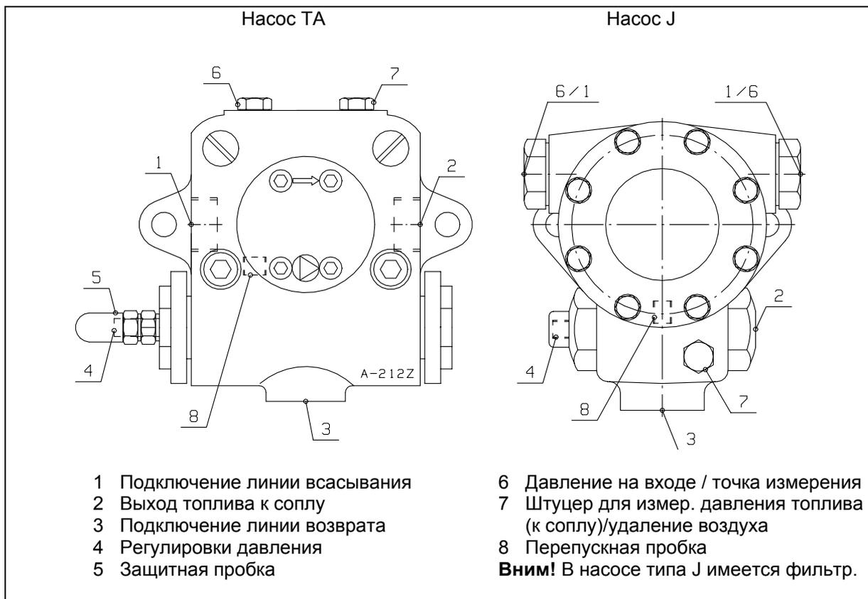
Максимальное давление топлива на входе в насос: насос ТА 5 бар
