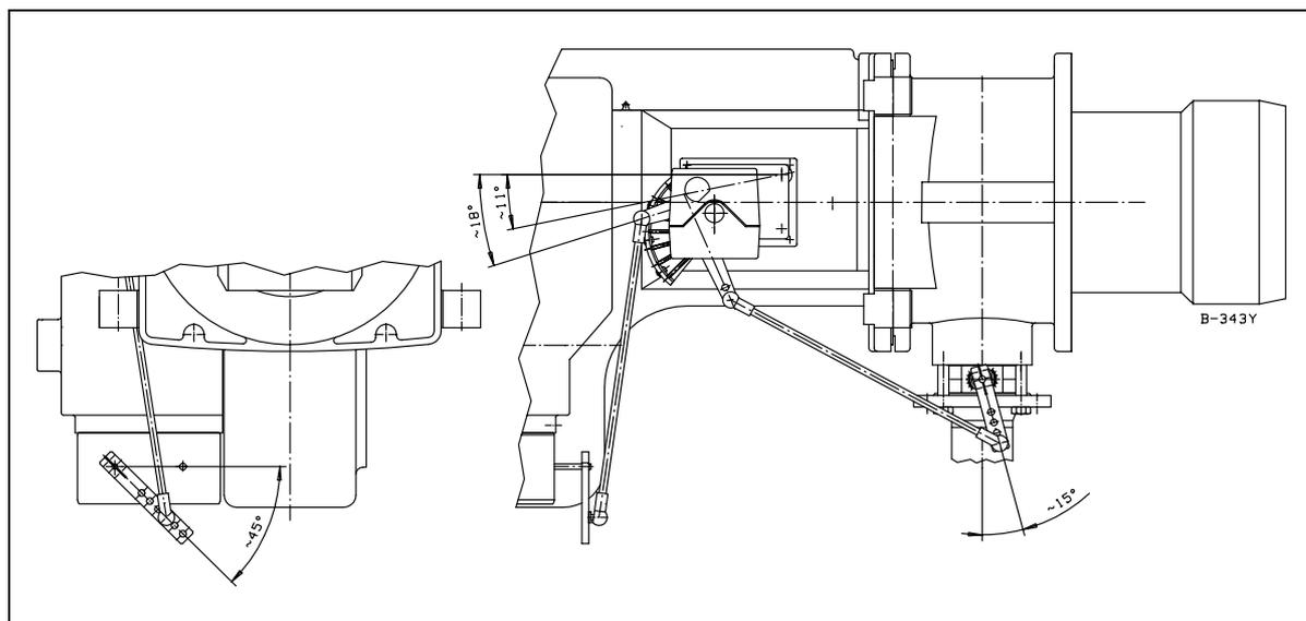
Положения рычагов на рисунке (положение сервомотора  $0^\circ$ ) являются условными. По необходимости они могут быть изменены, напр. в зависимости от производительности горелки, типа котла, рода газа.
