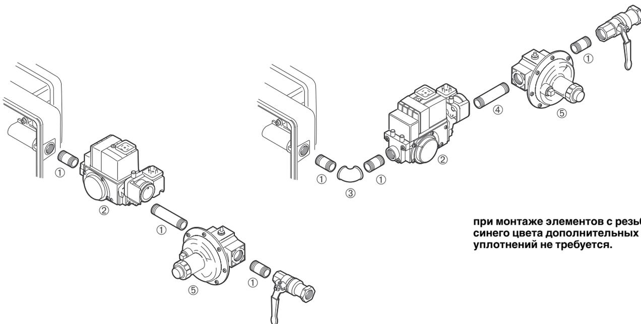
при монтаже элементов с резьбой синего цвета дополнительных уплотнений не требуется.
