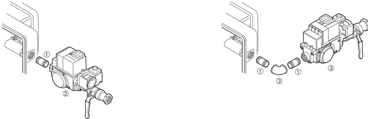
Пример монтажа арматуры при давлении подключения  $> 50 \dots 300$  мбар с регулятором давления FRS
