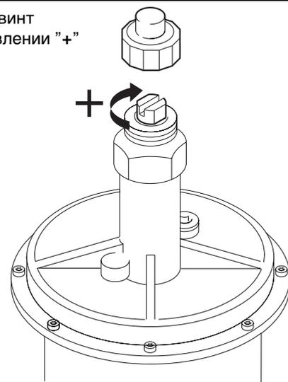
При помощи регулировочного винта можно снизить давление подключения до допустимого давления на входе мультиблока (прим. 20 мбар), разгрузив установленную на заводе пружину (оранжевая; 5...20 мбар). Настройку нагрузки зажигания на мультиблоке выбирать при давлении подключения 20 мбар!
