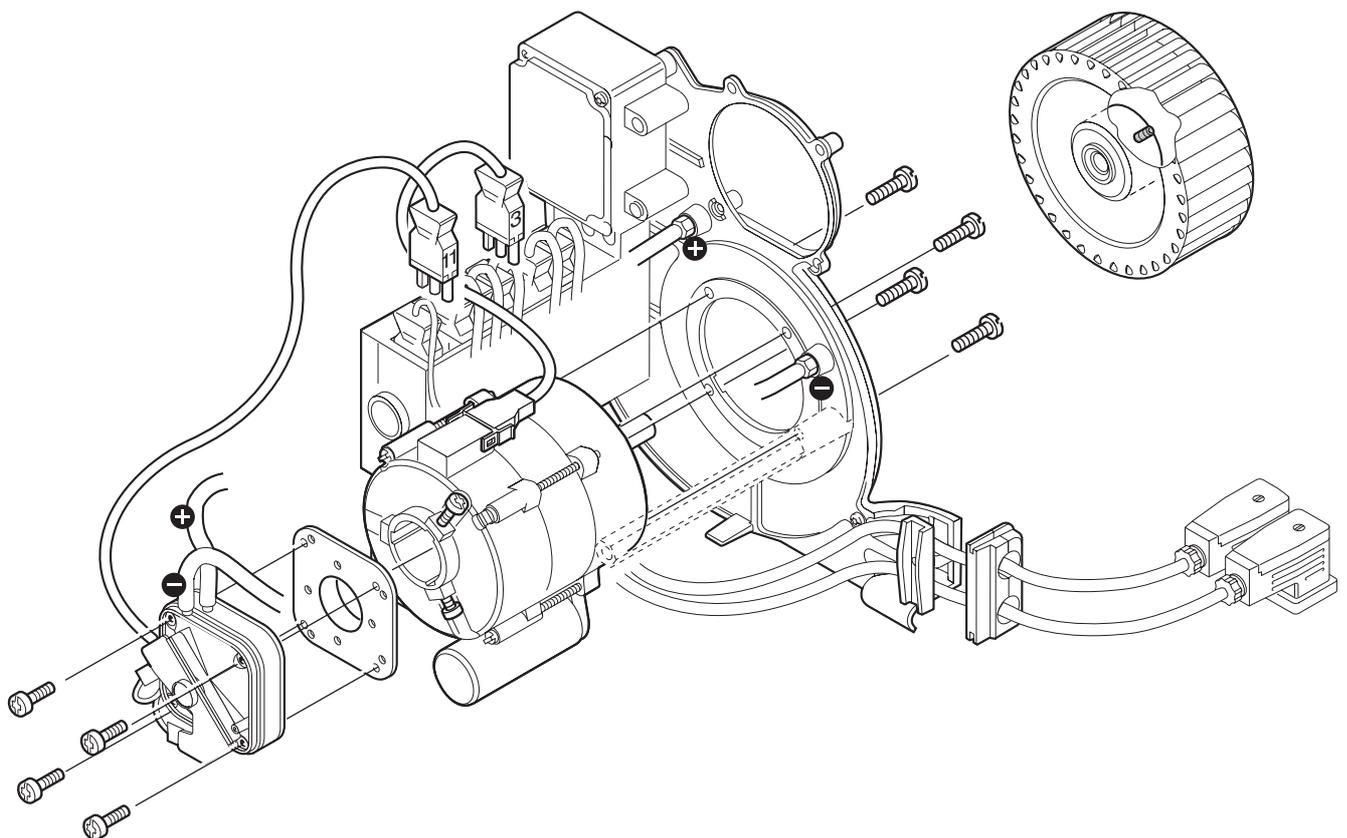
7.9 Демонтаж и монтаж магнитной катушки и печатной платы W-MF
