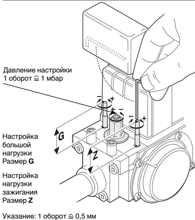
*Регулятор давления FRS при давлении подключения 50...300 мбар*
