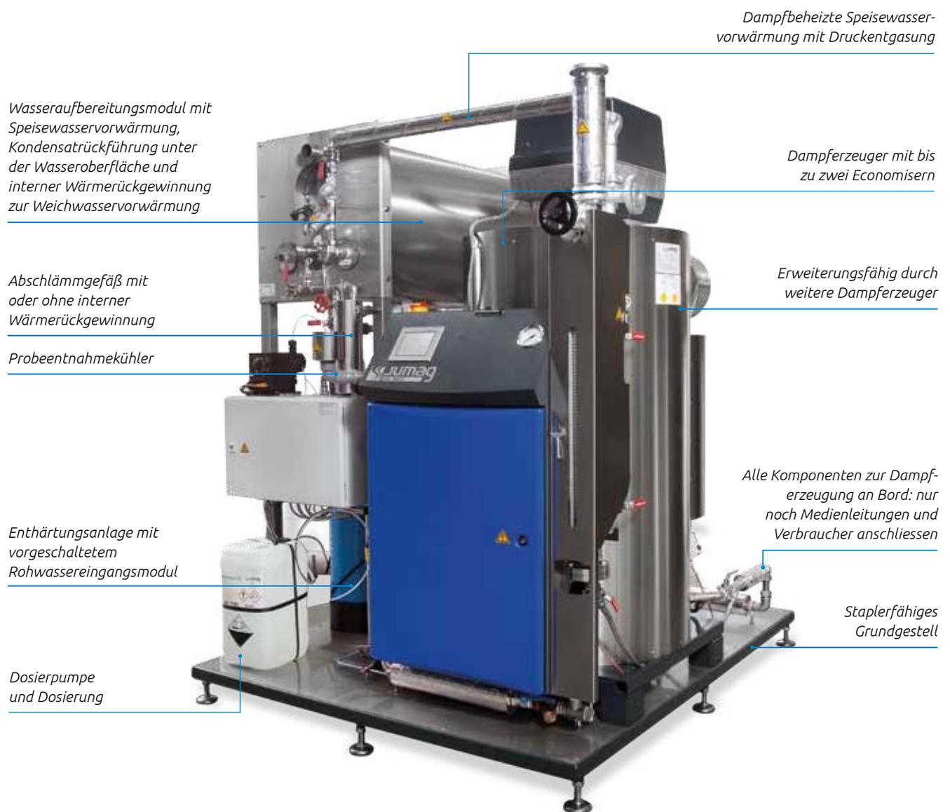
Abb.: Kompaktdampfanlage, Beispielkonfiguration
