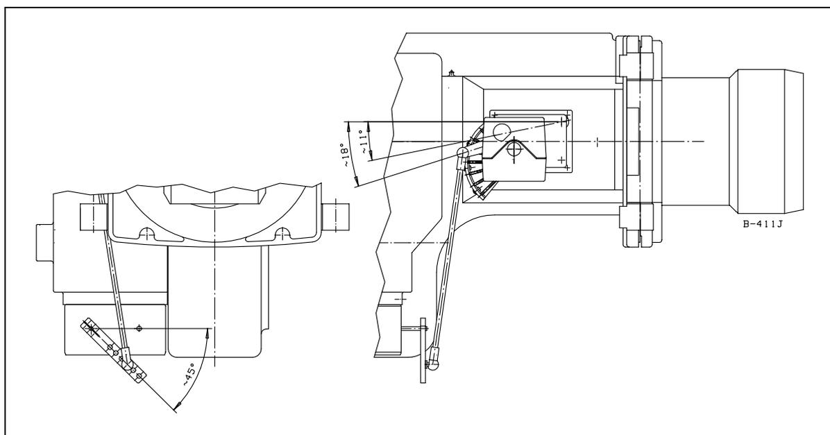
Положения рычагов на рисунке (положение сервомотора  $0^\circ$ ) являются условными. По необходимости они могут быть изменены, напр. в зависимости от производительности горелки, типа котла, рода газа.
