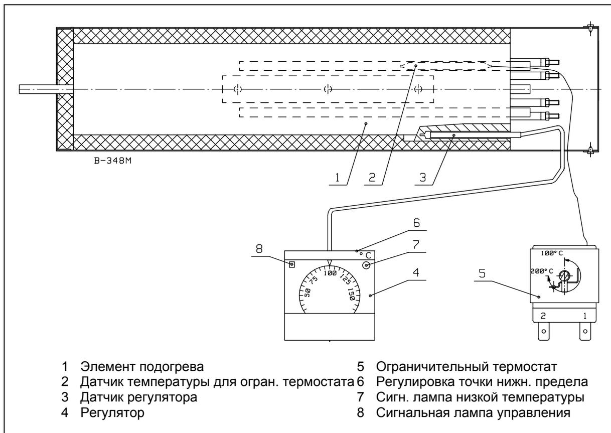
Датчик регулятора должен быть смонтирован как показано на рисунке.
