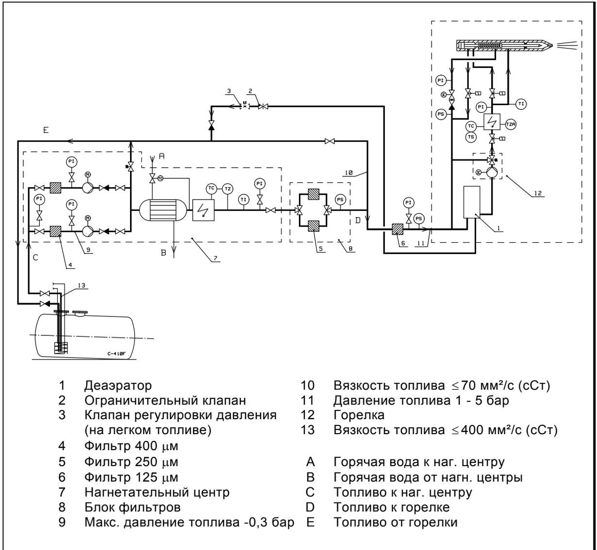
Производительность нагнетательного центра должна быть минимум 1,2 x (сжигаемое количество топлива кг/ч + 150 кг/ч).
