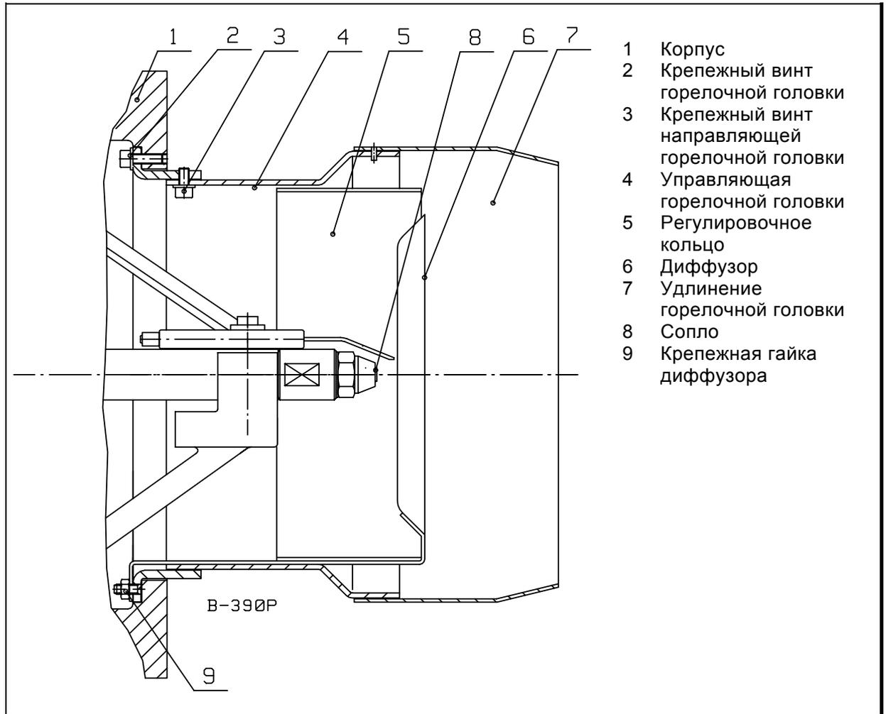
**Снятие горелочной головки**
