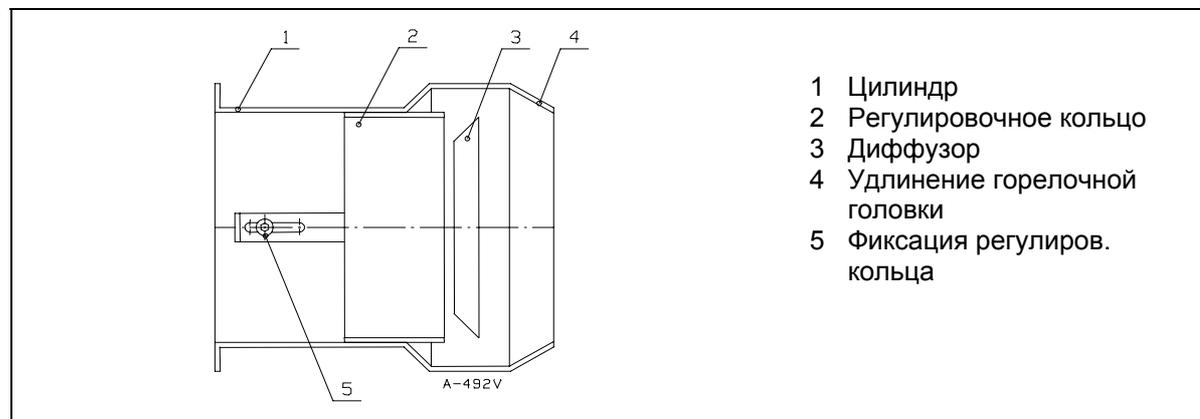
**Вним!** Если место кольца относительно диффузора меняется, также скорость и расход воздуха меняются. Проверьте результат сжигания анализом дымовых газов и подрегулируйте подачу воздуха.
