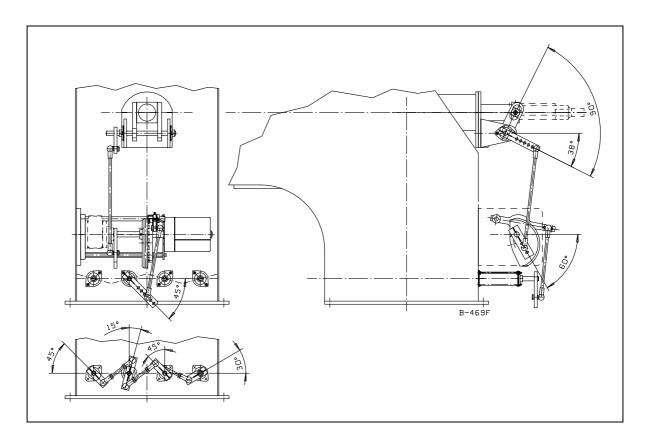
Положения рычагов на рисунке являются условными. По необходимости они могут быть изменены, напр. в зависимости от производительности горелки и типа котла.
