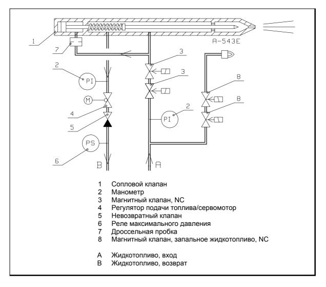
Предварительная продувка производится с объемом воздуха полной мощности. Во время предварительной продувки магнитные клапаны горелки закрыты. При этом топливо не подает в сопловой клапан а не на запальник.
