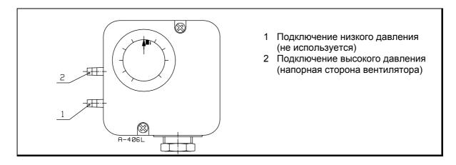
Реле давления воздуха контролирует давление воздуха в горелке. Если давление не превышает установленного в реле значения, горелка останавливается. Реле настроено на заводе-изготовителе. Если необходимо будет заменить реле давления новым, регулировка данного реле производится следующим образом: давление вентилятора измеряется при полной мощности. Реле давления отрегулируют на прибл. 50 % ниже результата замера.
